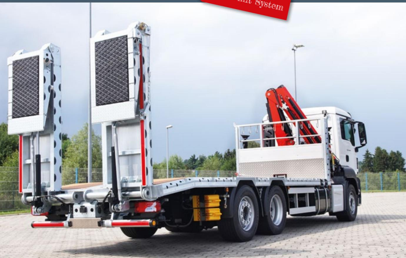
Mit dem Baustellentaxi hat Notterkran im Kundenauftrag ein schweizweit einzigartiges Fahrzeug entwickelt. Konstruktion und Aufbau erfolgten komplett durch Notterkran, der Kunde hatte im Projekt für den gesamten Aufbau einen Ansprechpartner. Das Fahrzeug verfügt neben einem Kran für die Aufnahme und das Absetzen von Baumaterial über eine Notterkran Plattformbrücke mit Spezialrampe, mit der sich schwere Baugeräte und -maschinen transportieren lassen.
